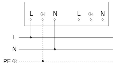
Diagrama electrónico interconexión maestro-esclavo y maestro-maestro
